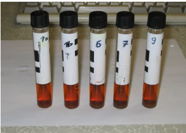
Abb: Proben mit Chloroform (links) und Toluol (rechts) als Lösungsmittel
